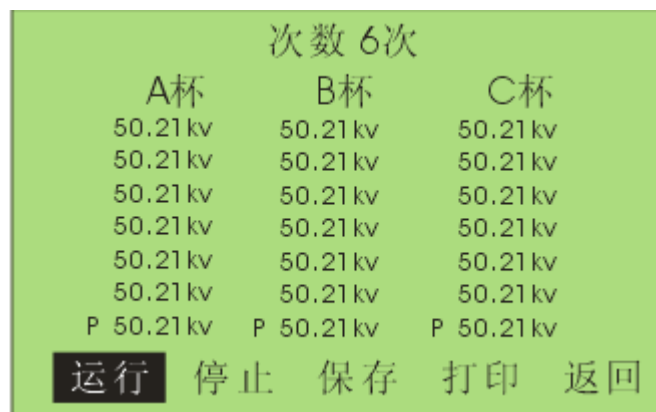
图 2.4 击穿试验结果显示界面
