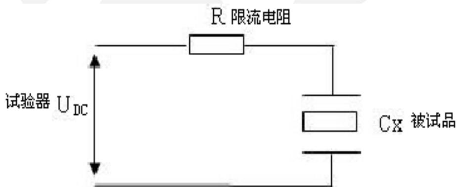
图 9 限流电阻使用示意图
