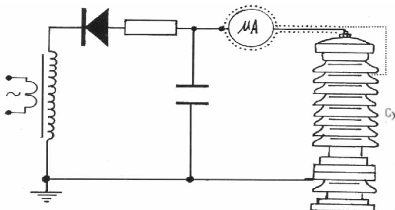
图 6 排除试品 CX 表面影响接线图
